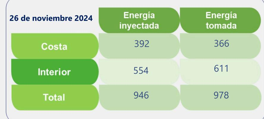
Las posibles diferencias presentadas entre el total de energía inyectada y total de entregas a usuarios finales puede ser ocasionada por almacenamientos en el sistema de transporte (empaquetamientos), pérdidas y consumos no reportados.
